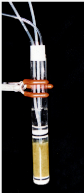
Système de perfusion pour la fluxomique par RMN in vivo avec utilisation de précurseurs marqués.
